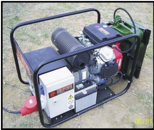
Şekil 3 : IP Ölçümünde güç kaynağı olarak kullanılan, jeneratör
