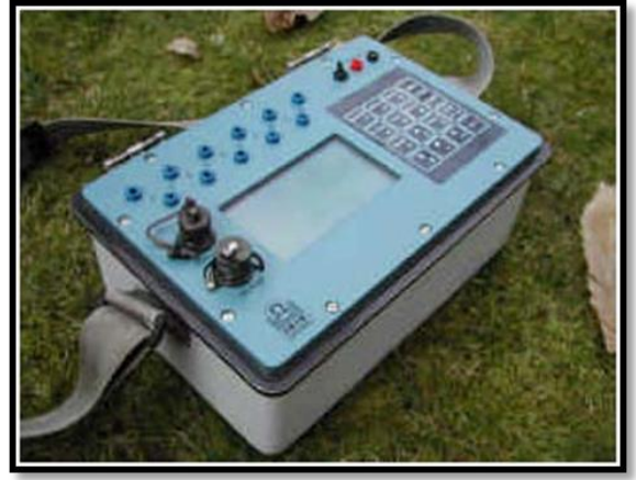
Şekil 5 : IP ölçümünde kullanılan, 10 kanallı kare dalga alıcısı
