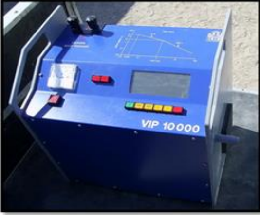
Şekil 4 : IP ölçümlerinde kullanılan kare dalga vericisi
