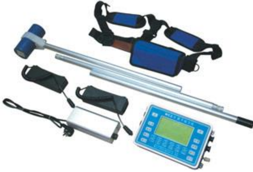
Şekil-4a. Proton Presesyon Manyetometresi
