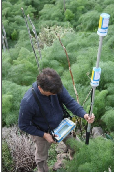
Şekil-3 Manyetik cihaz (Scintrex – Envi mag)
