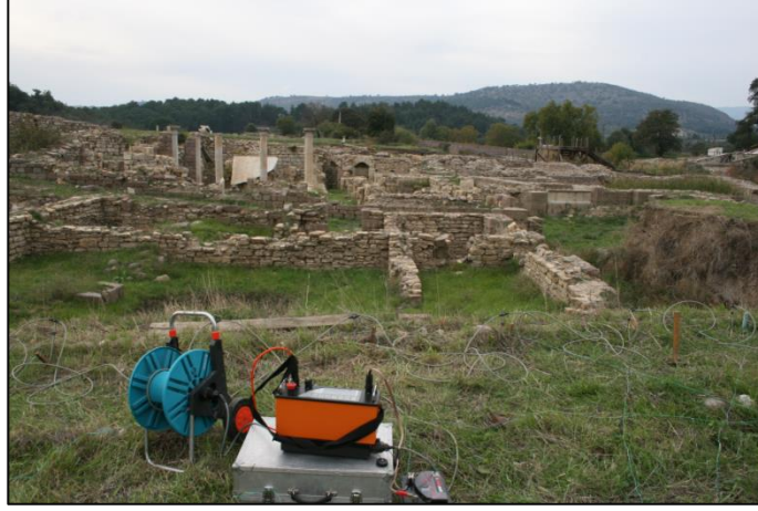
Şekil-2 Elektrik(rezistivite) cihazı ve ekipman
